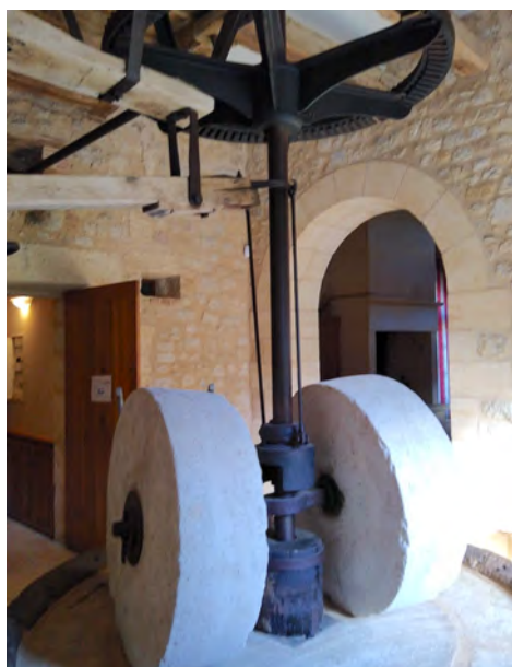
PHOTO 8.1 – Vue des meules destinées à produire l’huile de noix. Les dents de l’engrenage sont en bois
